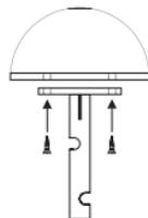
**Fixação do suporte:** utilizando os dois parafusos pequenos (2,9 x 6,5mm) prenda o suporte à base do sensor.
