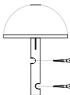
**Fixação do sensor:** utilizando os dois parafusos maiores (6") e suas buchas, prenda o suporte à parede ou ao poste.
