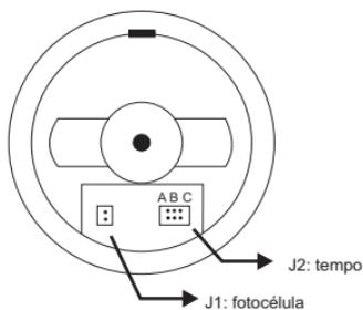
**J1 - LDR ON/OFF:** ativa ou desativa a fotocélula. Com o jumper J1 encaixado o sensor passa a funcionar apenas quando o ambiente estiver com pouca luz (à noite). Sem o jumper J1 o sensor funciona independente da iluminação ambiente.
