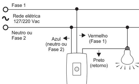
**Obs.:** Pode-se acionar um conjunto de lâmpadas, desde que a potência total seja inferior à do sensor. Para que dois ou mais sensores acionem a mesma lâmpada basta fazer a instalação dos sensores em paralelo, ou seja, ligando juntos os fios de mesma cor.
