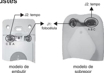
**J1 - LDR ON/OFF:** ativa ou desativa a fotocélula. Com o jumper J1 encaixado o sensor passa a funcionar apenas quando o ambiente estiver com pouca luz (à noite). Sem o jumper J1 o sensor funciona independente da iluminação ambiente.
