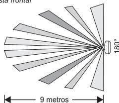
Para uma maior eficiência na detecção de movimento é recomendável a instalação do sensor perpendicular ao movimento de pessoas.
