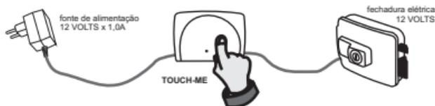
**Exemplo 1:** ligação de 1 TOUCH-ME e 1 teclado de senha TK-200 para acionar uma fechadura elétrica utilizando uma fonte de 12 Volts.
